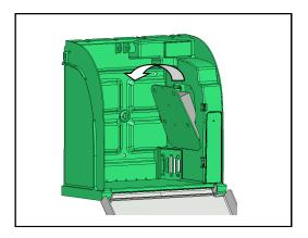
• Setzen Sie die 4 mitgelieferten Batterien D-LR20 unter Einhaltung der Pole, wie sie auf dem Boden der Batteriehalterung angegeben sind, ein.
