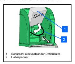
• Der Haltespanner ermöglicht das einfache Herausnehmen des Defibrillators im Notfall und gewährleistet die Instandhaltung des Geräts.
