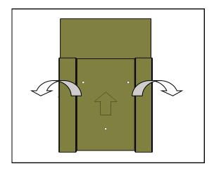
• Bringen Sie die Bohrschablone so an der Wand an, dass der Pfeil sichtbar ist und nach oben zeigt.
