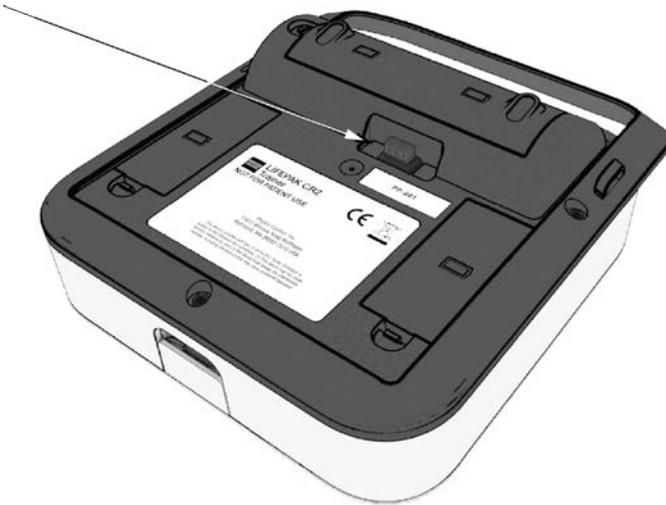
2. Schalten Sie das Trainingsgerät ein, entfernen Sie die Elektrodenablage und navigieren Sie zum Setup-Bildschirm. Notieren Sie sich die aktuelle Software Version, die unten im Hauptmenü angezeigt wird.
