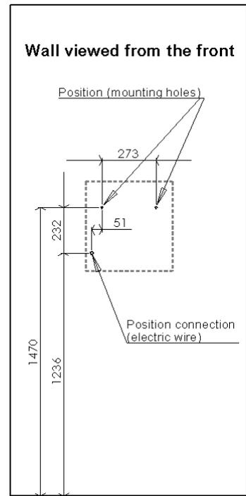
2. Das Gehäuse ist durch die zwei Löcher auf der Rückseite an der Wand oder auf einem Ständer zu montieren.
