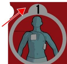
Falls der Übergangswiderstand (Impedanz) inakzeptabel ist, wird der Anwender aufgefordert, die Elektroden zu überprüfen; zudem blinkt die grüne LED (siehe Pfeil).
